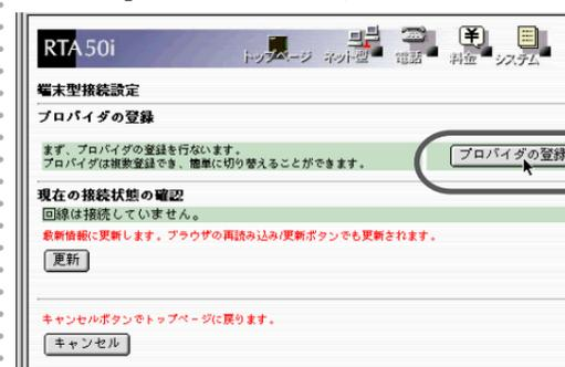
**16** プロバイダ名、ISDN対応アクセスポイント電話番号、ユーザ名、パスワード、ネームサーバのIPアドレスを入力し、[登録]ボタンを押します。アクセスポイント電話番号、ユーザ名、パスワード、ネームサーバのIPアドレスは、プロバイダから通知されたものを入力してください。メッセージに従ってボタンを押すと、設定が登録されて「端末型接続設定」ページへ戻ります。
