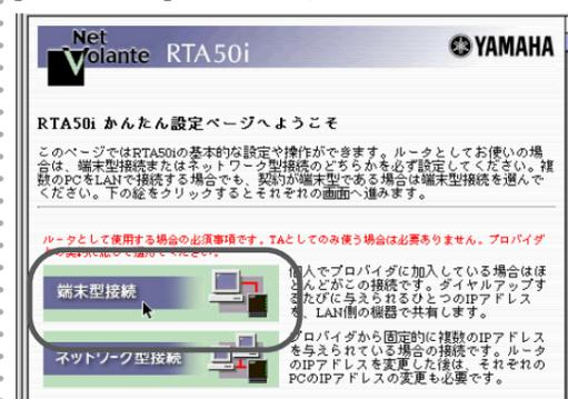
**15** 「端末型接続設定」ページが表示されたら、[プロバイダの登録]ボタンを押します。
