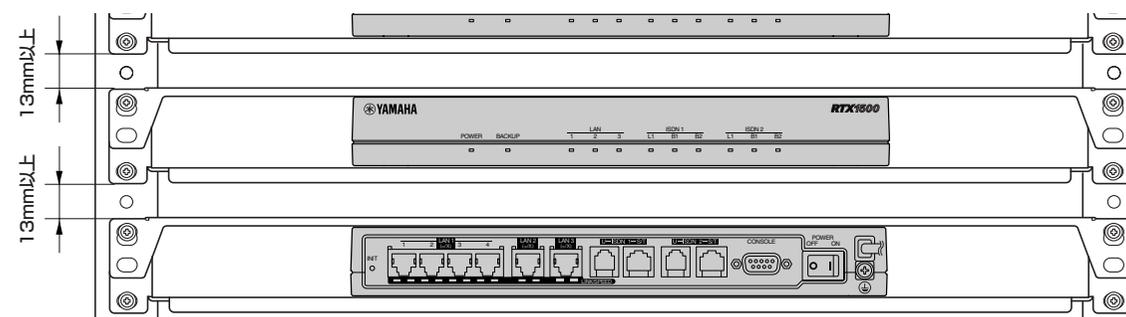
**ヒント** ・ EIA規格の19インチラックに取り付ける際、本製品の上下にネジ1個分のすきま(13mm以上)を設けておくと、ラックマウントパネル(上)を取り外すだけで(ラックにマウントしたまま)、本体を交換することができます。
