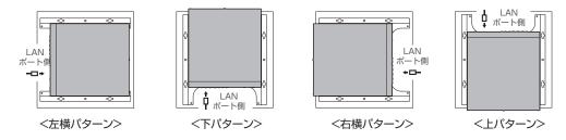
手順1で印をした取り付け位置に、市販のネジ(4本)を仮止めします。その際に、壁とネジのくび下に1mmのマウント金具引っ掛けしろを残してください(右上図)。
