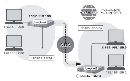
ポイント①に対して応答がない場合には、ルーター A の経路情報が間違っている可能性があります。 ポイント②に対する応答がない場合には、そのパソコンのデフォルトルートの設定が間違っているか、パソコンのファイアウォールにより ping が破棄されている可能性があります。 コマンドの詳細は「コマンドリファレンス」(ウェブサイト)を参照してください。
